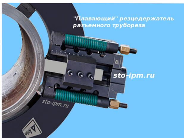
Копир нивелирует овальность трубы и неравномерность толщины стенок в разных точках окружности реза. Кроме того, плавающий резцедержатель исключает аварийные заклинивания инструмента, когда в начале резки из за овальности в одной точке реза инструмент еще не касается трубы а в другой подача на зуб может оказываться запредельной. Также плавающий резцедержатель позволяет сократить время установки разъемного трубореза на трубе т.к. допускает в
