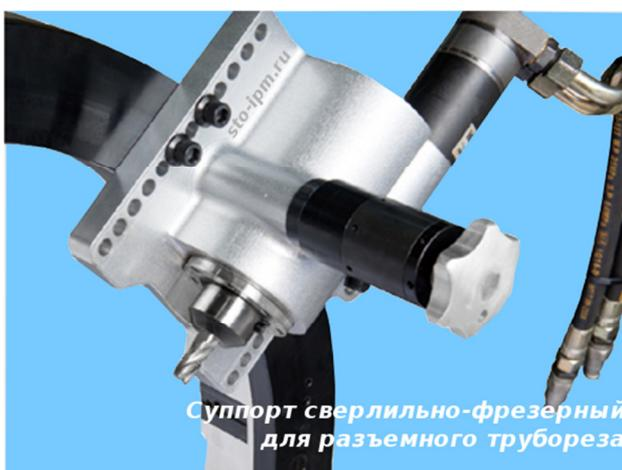
Шпиндель имеет ручную подачу перпендикулярно к оси. Позволяет выполнять сверление или фрезерования на торце или плоскости трубы. Устанавливается в места крепления вместо штатного суппорта резцедержателя.
