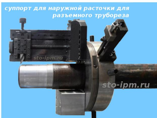
Суппорт для проточки наружного диаметра имеет ход вдоль оси трубы до 200мм. Ход перпендикулярно к оси трубы до 100мм.
