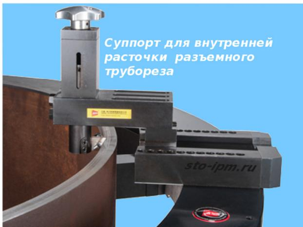
Конструкция суппорта для расточки позволяет перемещать специальный резец для расточки вдоль оси со стороны внутренней поверхности трубы на нужную длину до 100мм. Глубина расточки регулируется приводом резцедержателя, на котором установлен суппорт для расточки.
