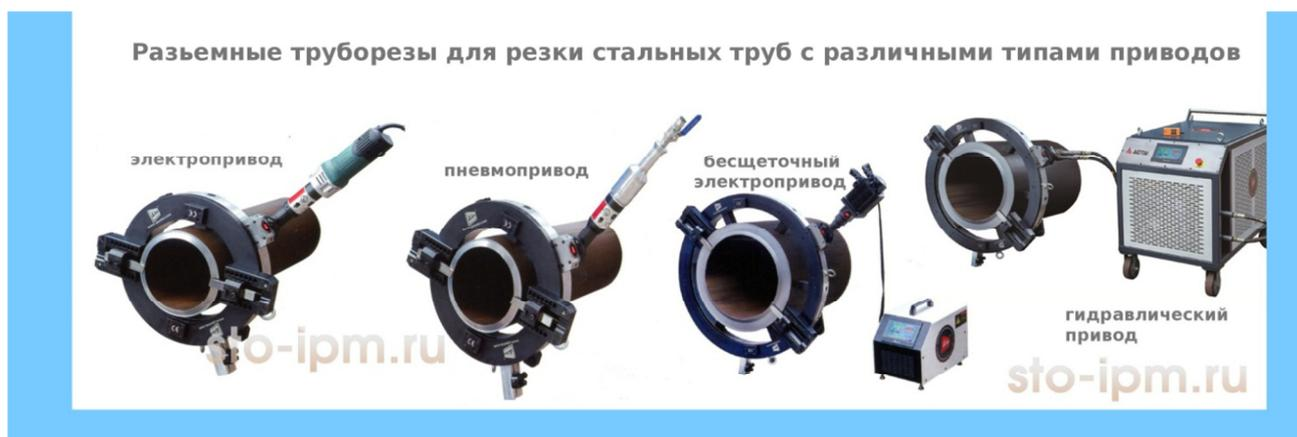
Разъемные труборезы предполагают возможность использования различных типов приводов:
